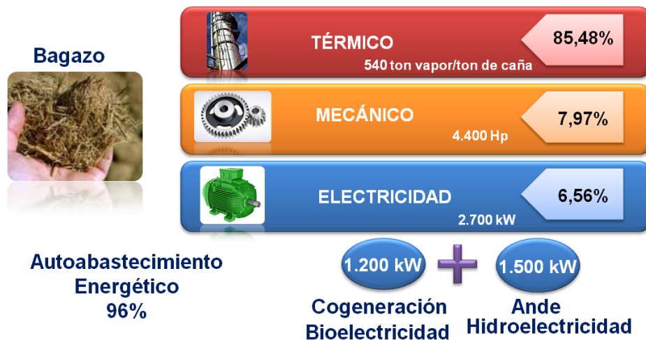
Figura 8 Requerimientos energéticos del ingenio
