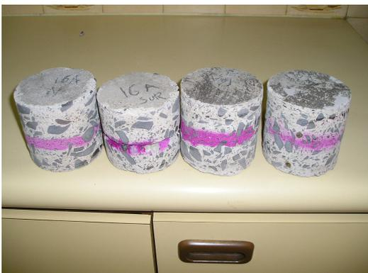
Foto N° 6 : Frente carbonatado de unos 40 mm en algunos balcones
