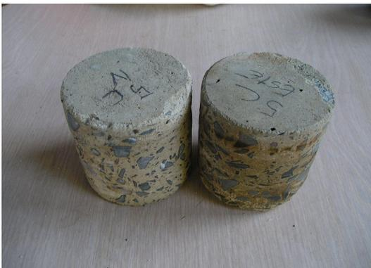
Foto N° 7 : Frente carbonatado de 50 mm en algunos balcones (total)
