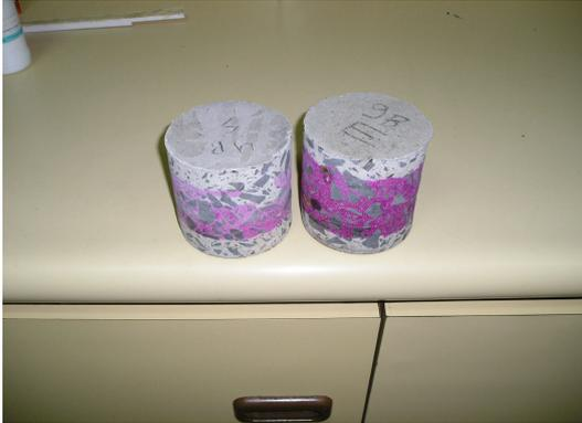
Foto N° 5 : Frente carbonatado de unos 20 mm en algunos balcones
