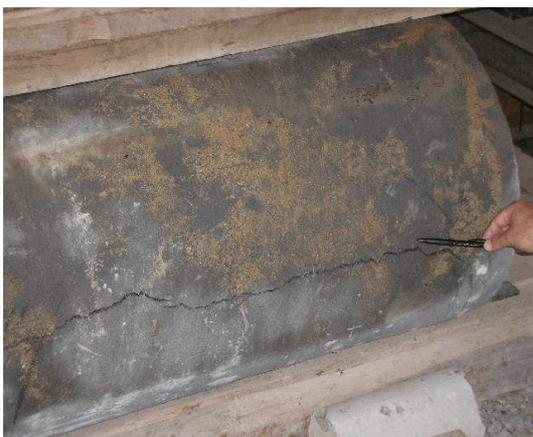
**Foto 5.2** Comportamiento de los Tubos de Hormigón con fibras de acero ensayados a Compresión Diametral. Fisuras longitudinales internas (Foto Izq.) y externas (Foto Der.)
