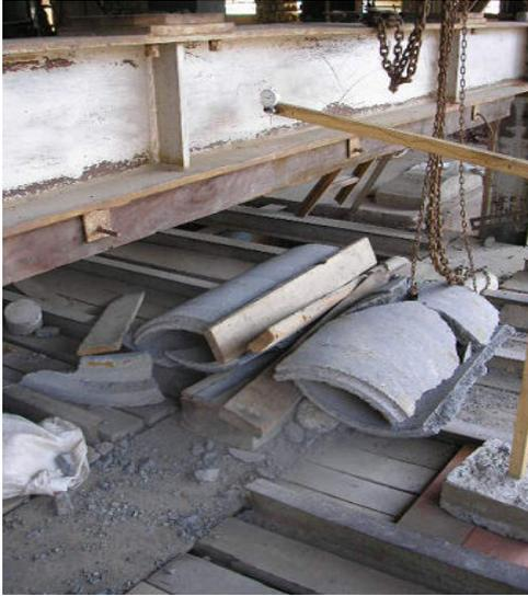
**Foto 5.1** Comportamiento de los Tubos de Hormigón convencional ensayados a Compresión Diametral.
