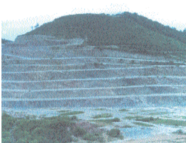
Serranas de piedra caliza en la zona Valle-mi utilizadas para de fabricación de cemento y como agregado grueso del hormigón.
